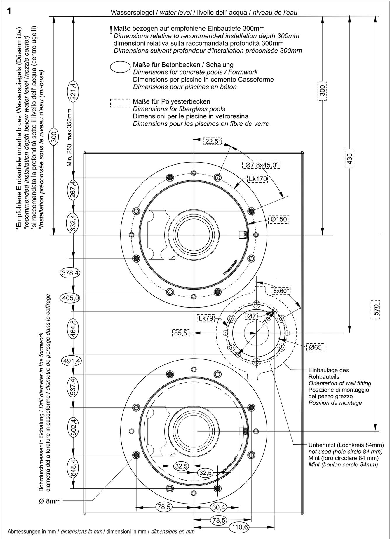
2.2 Einsetzen des Rohbauteils in die Schalung (Bild 2)
