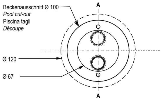
**Schnitt / section / sezione / section A-A**
