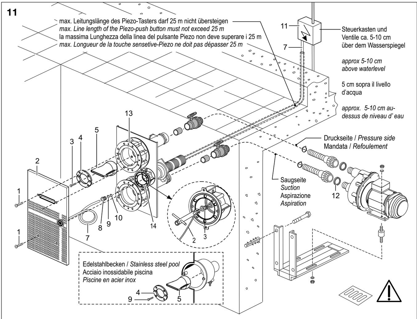
Schwingmetall (Stossdämpfer) auf die Konsole oder, wenn Sie einen Sockel betonieren möchten, unterbauen Sie diesen entsprechend. Kleben Sie mit „TANGIT“ den Saug- und Druckschlauch in die Übergangsmuffe des Rohbauteils. Nach dem Kleben sollten sich die Kugelhähne öffnen und schliessen lassen.
